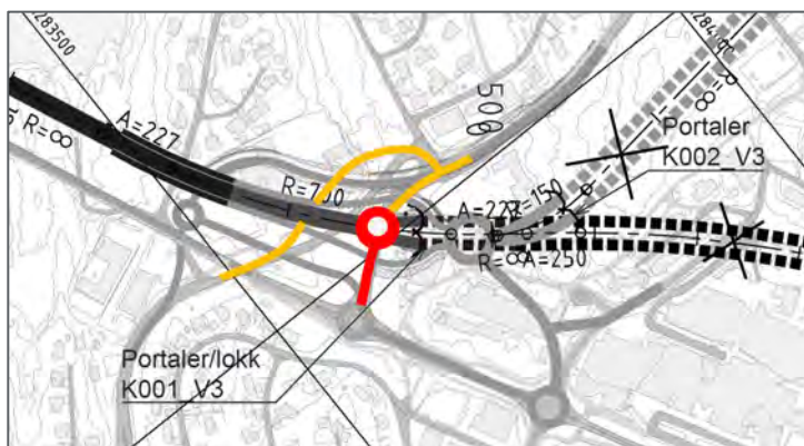
Figur 10 Byggetrinn 1b, prinsipp for midlertidig kryss i Knarvik, alternativ V3 og V4.
