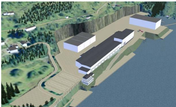
Figur 8 3d-modell som viser utsprenging og planering sett frå nordvest
